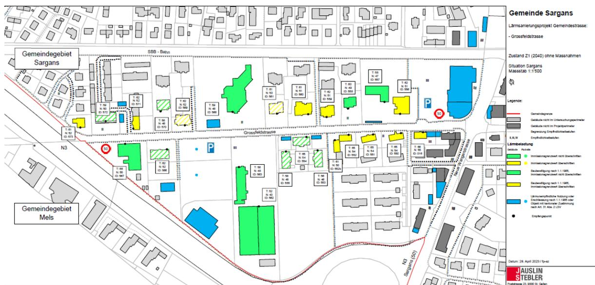
Abb. 22: Lärmsituation 2040 ohne Lärmschutzmassnahmen (Quelle: Jauslin Stebler AG)
